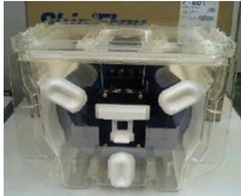
記録計の設置(Y方向:上下、Z方向:前後、X方向:左右)
