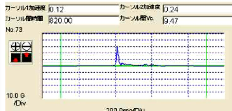
コインスタック最大加速度波形(3方向合成加速度)
